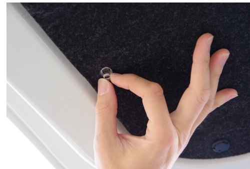
ナットを埋め込む位置に穴あけ加工をし、ターンナットを埋め込みます。ビスを軽く押し、ナット部分を回転させます。しっかり回転した状態でビスを止めていきます。しっかりと締め付けて取り付け完了です。
